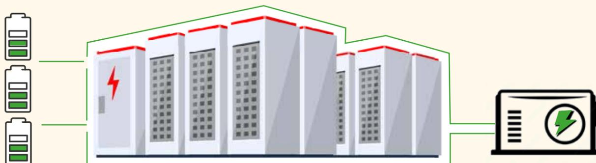
**BATTERIEN:** Das FL1 Festnetz und die Internetversorgung werden auf jeder Ebene durch ein unterbrechungsfreies Stromversorgungssystem mittels Batterien geschützt
